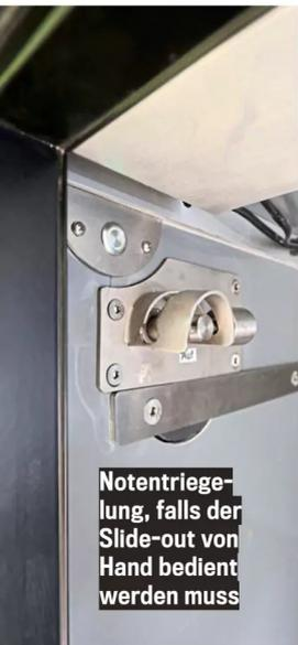
Notentriegelung, falls der Slide-out von Hand bedient werden muss
