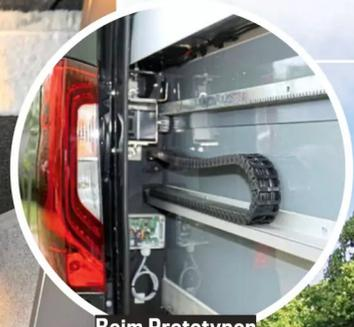
Beim Prototypen liegen Teile des Förderbandmotors des Auszugs frei. In den Serienmodellen sind diese unsichtbar verbaut
