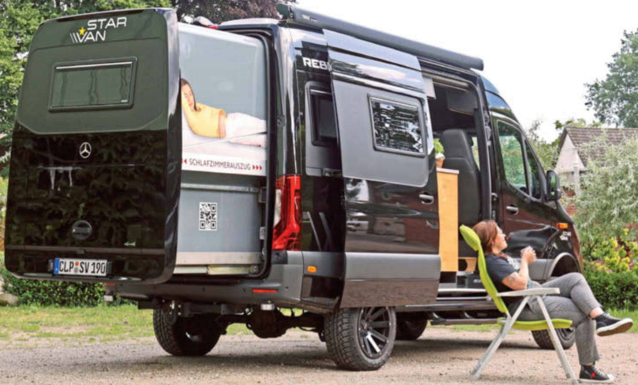
Im Campingmodus lässt sich der StarVan dank des Slide-outs von 5,93 auf 7,13 Meter verlängern und schafft so viel Platz im Heckraum des kompakten Kastenwagens auf Mercedes-Sprinter-Basis
