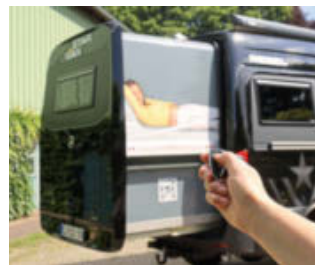
Im Campingmodus lässt sich der StarVan dank des Slide-outs von 5,93 auf 7,13 Meter verlängern und schafft so viel Platz im Heckraum des kompakten Kastenwagens auf Mercedes-Sprinter-Basis
