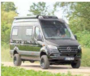
Im Campingmodus lässt sich der StarVan dank des Slide-outs von 5,93 auf 7,13 Meter verlängern und schafft so viel Platz im Heckraum des kompakten Kastenwagens auf Mercedes-Sprinter-Basis
